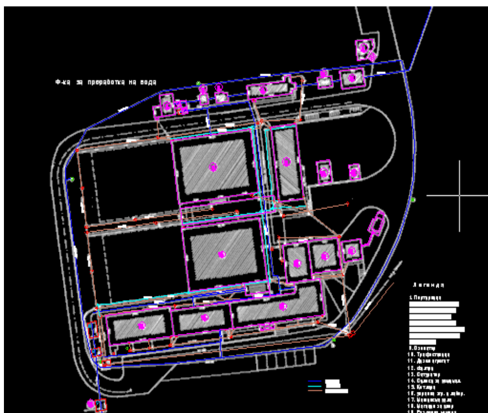
Слика 3 Шема на филтер станицата за вода за пиење во Град Велес
