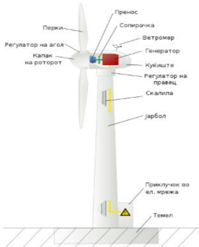
Слика 25 Напречен пресек на типична голема ветерна турбина со сите составни делови
